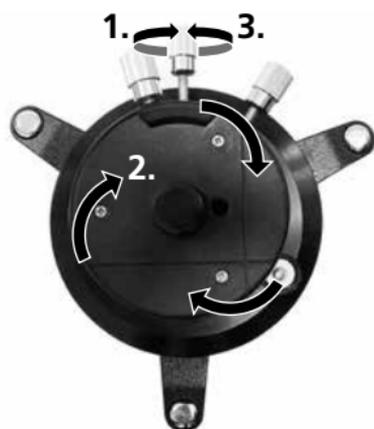
Réglage au moyen de la commande latérale de précision
