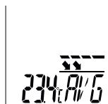
De modi Max./Min./AVG hebben betrekking op de infrarood-temperatuur en geven de maximale, minimale of gemiddelde infrarood-temperatuur weer. De Max./Min./AVG-waarden worden tijdens de lopende meting bij ingedrukte activeringstoets (9) bepaald. Bij de start van een nieuwe meting resp. door indrukken van de activeringstoets (9) wordt de waarde gewist en opnieuw berekend.
