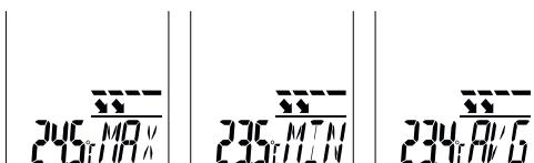
Moderne Max/Min/AVG relaterer til den infrarøde temperatur og angiver altid den maksimale, minimale eller gennemsnitlige infrarøde temperatur. Max/Min/AVG-værdierne bestemmes under den igangværende måling, når udløseren (9) holdes inde. Ved start af en ny måling, eller hvis man trykker på udløseren (9), slettes og genbereges værdien.
