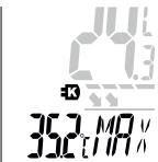
! De MIN-MAX-waarden worden bij een moduswissel en bij het in-/uitschakelen van het toestel gewist.
