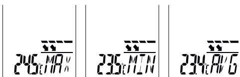
Los modos Max/Min/Avg hacen referencia a la temperatura por infrarrojos e indican la temperatura máxima, mínima y media respectivamente. Los valores de máxima, mínima y media se calculan durante la medición con el botón de activación (9) pulsado. Al inicio de una nueva medición, o al pulsar la activación (9), se borra el valor y se calcula de nuevo.
